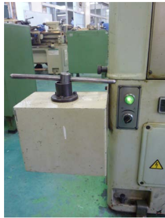
旋盤の左下に安全装置あり (チャックハンドル挿入で主電源が入る)
