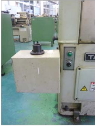
旋盤の左下に安全装置あり (チャックハンドル挿入で主電源が入る)
